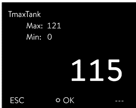
Fig. 43: Enter new Tmax/Tank
